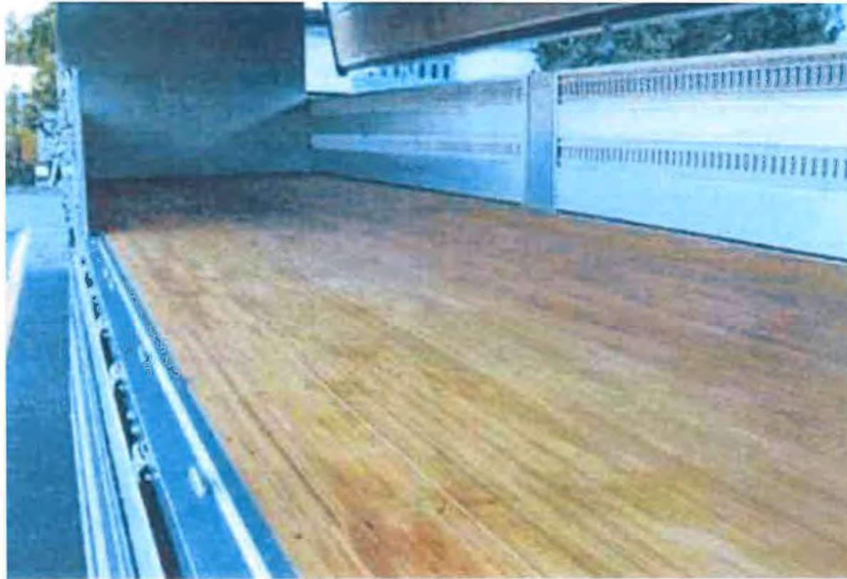
竹の合板を使用したトラック床材
