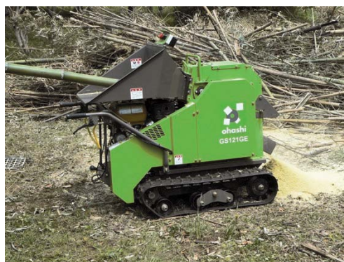
写真7 竹用の粉碎機によるチップ化
